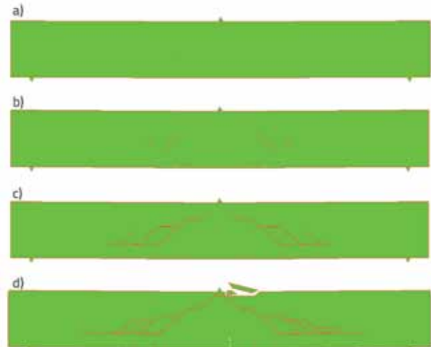
Slika 12. Pukotine na konstrukciji za opterećenja: a) F=216,0 kN; b) F=259,0 kN; c) F=261,0 kN; d) F=261,1 kN
